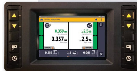
Il display Trimble Roadworks 2D è dotato di tastiere fisiche, ideali per l'uso diretto in cantiere
